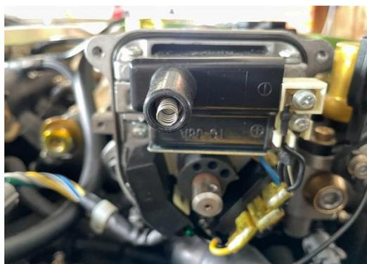
3、専用ディスビローター（HPD110）を取り付けてください。
