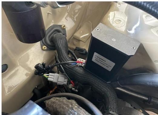
参考車両は、バッテリー搭載位置が変更になっていたため、ストラットに両面テープで固定しております。
