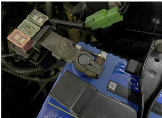
配線が弛んで、可動部などに接触しない様に配線の取り回しをして、タイラップで固定して下さい。コントロールユニットまではインテークマニホールドの上を這わせてください。
