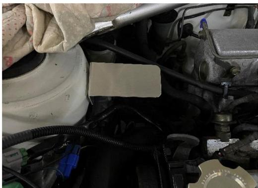
16、付属の両面テープを2枚重ねにしてコントロールユニットに貼り付け、L型ブラケットに固定してください。
