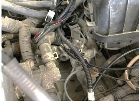
ディスビからの信号ハーネスもタイラップで必ず固定して可動部に絡んだり排気マニホールド接触する
