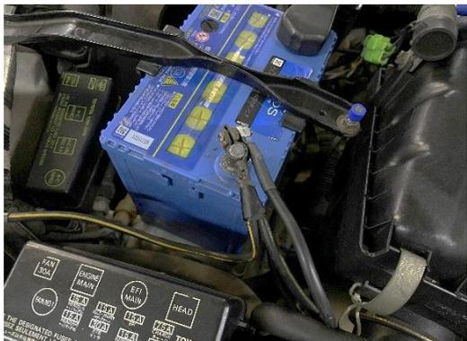
13、電源ハーネス（DP032）をバッテリーのプラスターミナルに接続し、反対側はコントロールユニットの赤線に接続してください。
