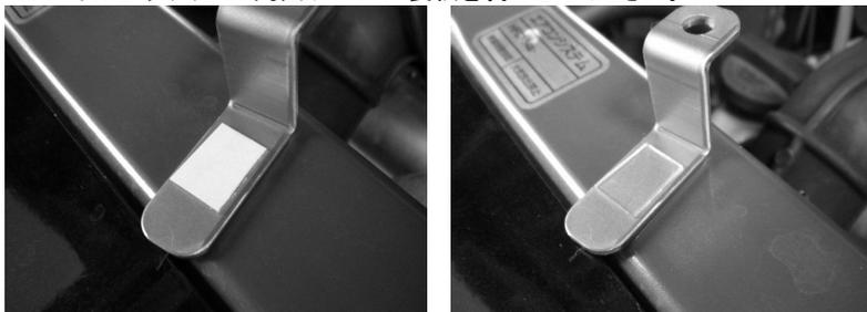
7. Ignite REVコイルがプラグホール中央にあることを確認し、コイルブラケットを付属の6X15ボルトにて固定してください。
