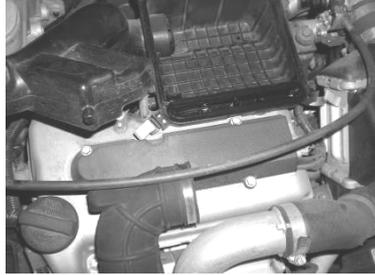
3. コイルカバーを外し、点火コイルを外してください。(取り外したコイルカバー及び点火コイルは使用しません。)
