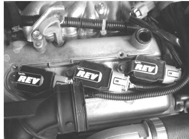
8. アーシングをしていない車両の場合、付属のグラウンディングケーブルをエンジン本体とボディに接続し、
