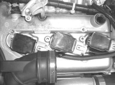
6. コイルブラケットの両面テープの裏紙を剥がしてコイル中央に載せてください。
